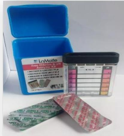
**La medición de cloro residual del agua deberá encontrarse en el rango de 0.2 - 1.5 ppm**
